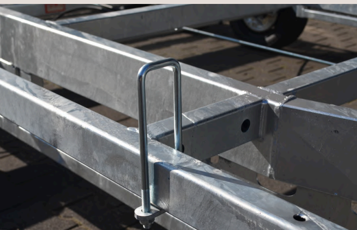
U-Bügel 190 mm lang mit Platte
