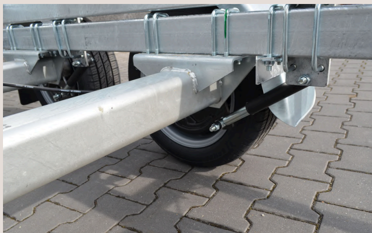
Stoßdämpfer pro Achse montiert
