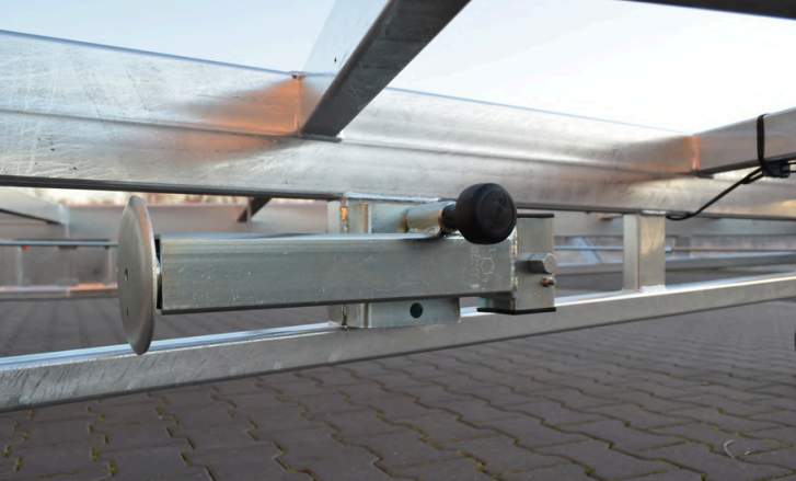
Stützbeine für Anhänger (4x1300 kg)
