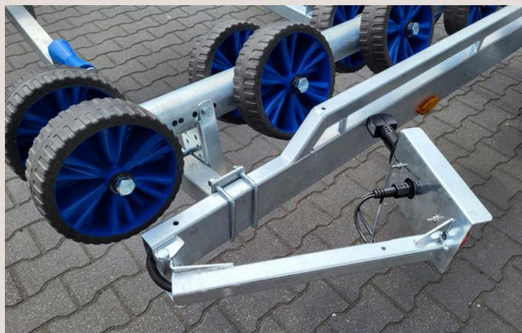
Klappbare wasserdichte LED-Beleuchtung
