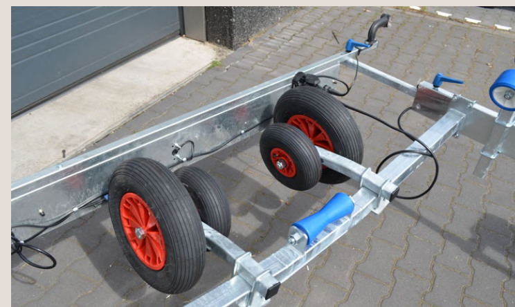
Auffahrhilfe mit vier Luftbereiften Rollen
