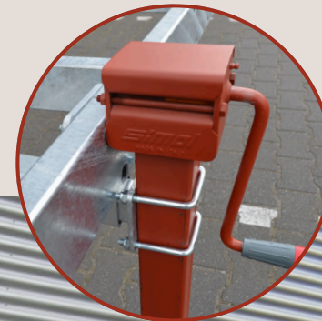
Rode steunpoot gemonteerd
