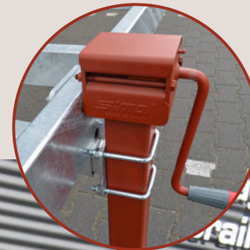
Rode steunpoot gemonteerd
