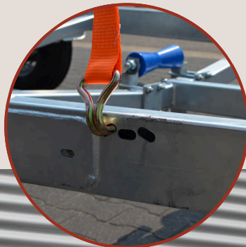
Gaten bevestiging spanband
